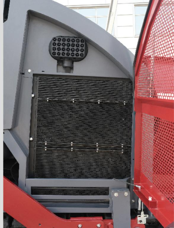
优化设计发动机散热系统，提高整机极限工作温度；
