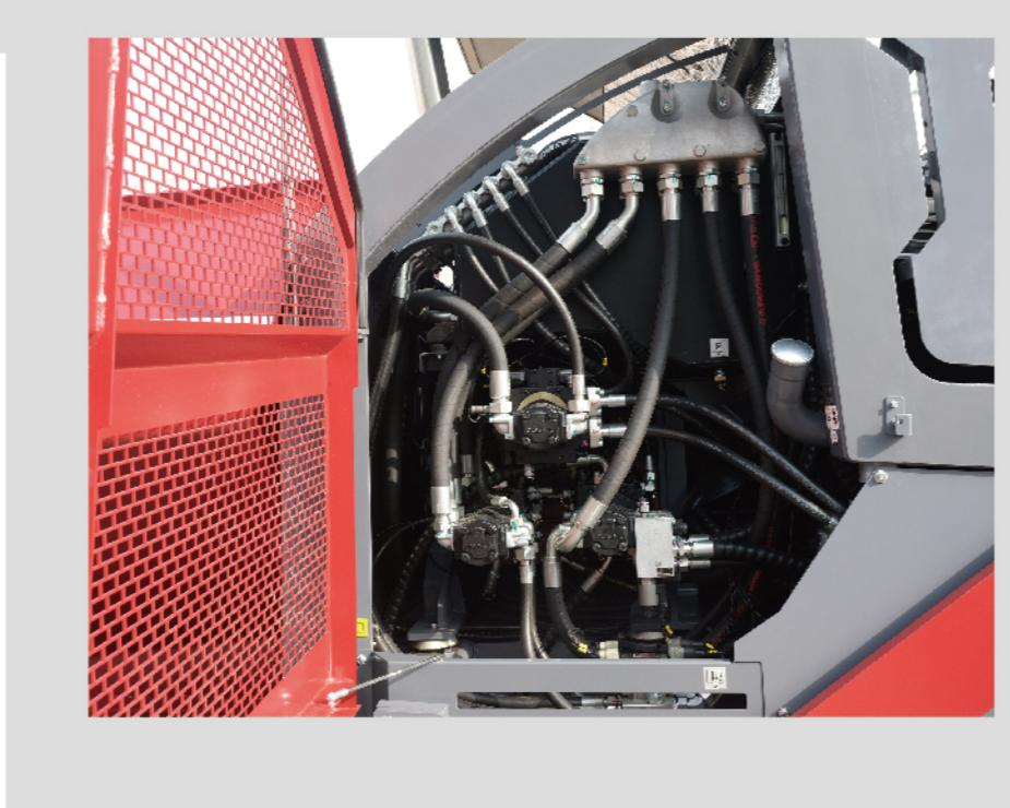
配备左/右开孔侧门，形成良好散热通道；
